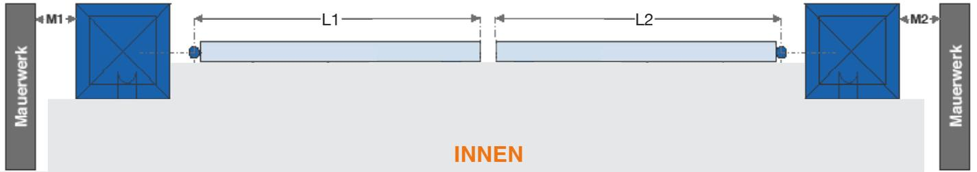
Den Pfostenmaßen fällt bei der Motorisierung von Drehtoren eine besondere Bedeutung zu. Messen Sie bitte die erfragten Maße sorgfältig aus und tragen diese ein.
